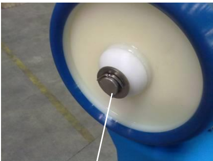
Rueda fija con una arandela plana a ambos lados de la rueda. Pasador de vacheta para fijación.
