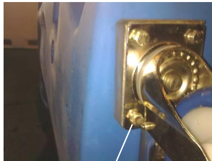
Fijaciones M8 para el montaje de las ruedas giratorias.
