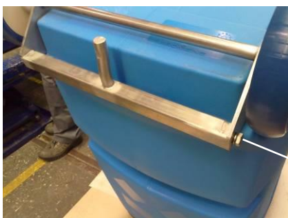
Fijaciones M10 para la fijación del parachoques.
