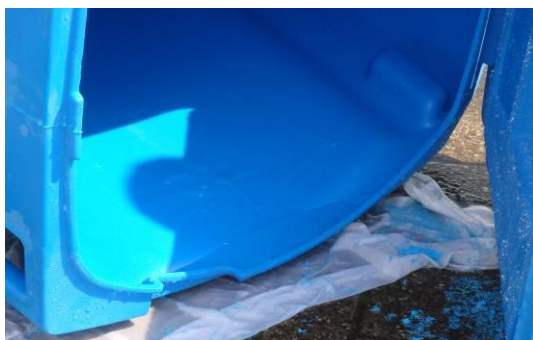
Position du Drumtainer pour un drainage optimal
