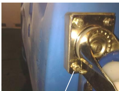
Fixations M8 pour le montage des roulettes pivotantes
