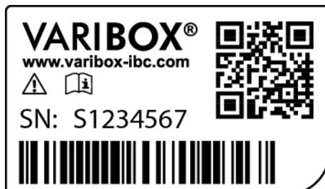
Jede VARIBOX und jeder Innenbehälter haben eine eindeutige Seriennummer. Diese Nummer (SN) ist auf einem Label angegeben: auf der Vorderseite der VARIBOX und auf der Oberseite des Innenbehälters.
